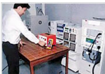
ขณะทำการทดสอบ voltage dips
