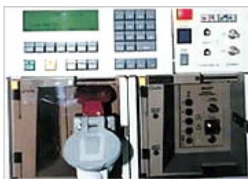
เครื่อง EFT generator
