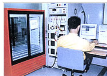
การทดสอบ current harmonics emission
