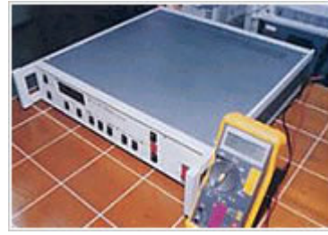
การทดสอบภูมิคุ้มกัน SURGE กับเครื่องควบคุมตำแหน่ง
