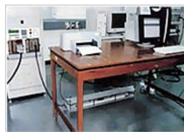
การทดสอบ EFT กับเครื่องพิมพ์
