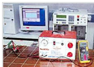
การทดสอบ voltage dips
