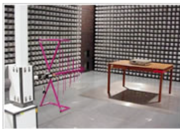
การทดสอบ Radiated EMI
